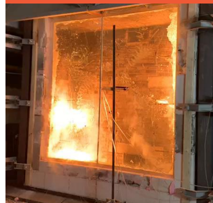
Испытания перегородки с безрамным стыком стекла
