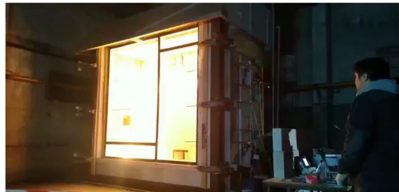
Испытание наружной несущей стены со структурным остеклением (E30, 1500x2600мм)
