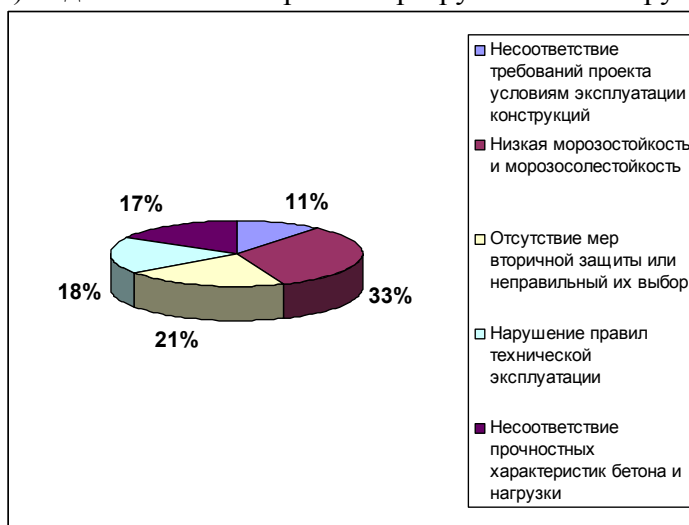
Рисунок 1 – Причины, вызывающие преждевременное разрушение строительных конструкций
